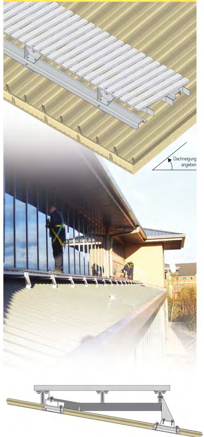
Laufsteg auf Metalldach mit verdeckter Befestigung
